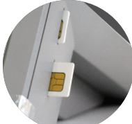
Zwei versiegelbare Plug-Ins zum sicheren Einbringen von SMC-KT und SMC-B
