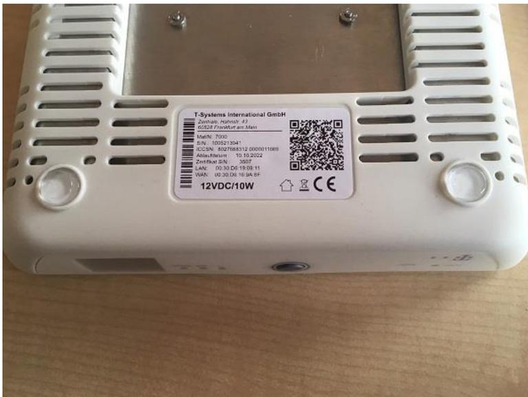
**Wichtig:** Das Typenschild zeigt das Ablaufdatum des Zertifikates und somit die maximale Nutzungsdauer des Konnektors. Es sind keine Installationsfristen oder Zeiträume einzuhalten. Durch eine spätere Inbetriebnahme verkürzt sich nur die Nutzungsdauer des Gerätes.
